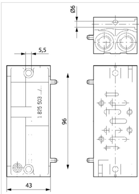
Fig. 3 Anschlüsse 2 und 4 seitlich 12 und 4 zusätzlich nach unten Steuerdruckanschluss 12+14:
