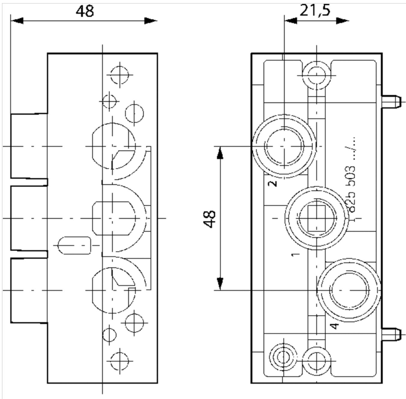
Fig. 1 Anschlüsse 2 und 4 seitlich Steuerdruckanschluss 12+14: Einzelanschluss
