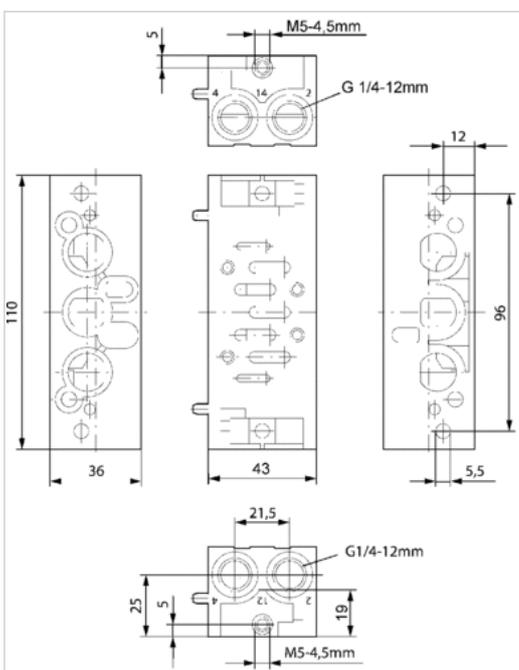
Fig. 2 Anschlüsse 2 und 4 seitlich Steuerdruckanschluss 12+14: zentraler Sammelanschluss
