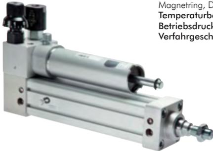
**Werkstoffe:** Deckel, Boden und Rohr: Aluminium eloxiert, Kolbenstange: Stahl hartverchromt, Kolben: Aluminium mit Magnetring, Dichtungen: NBR/Polyurethan
