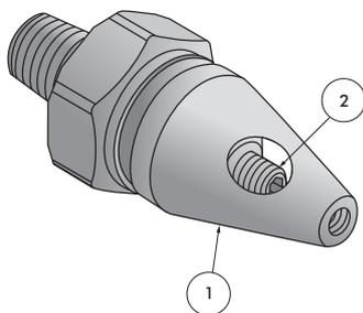
Die Düsen Spitze (1) ist mit einer Inbusmadenschraube (2) gesichert. Diese ist vor dem Verstellen zu lösen.
