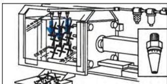
**⚠ Achtung:** Verwenden Sie für das Einschrauben in BLP 14: RN M12x1,25-14 MS / RN M12x1,25-18 MS
