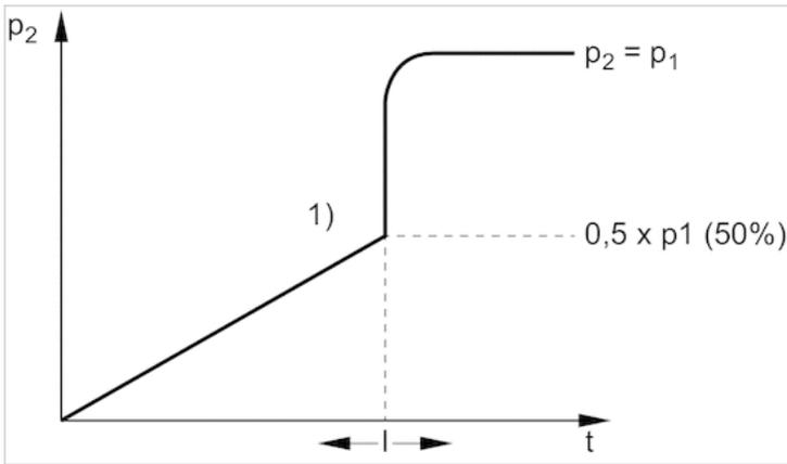
$p_1$  = Betriebsdruck  $p_2$  = Ausgangsdruck = Befüllzeit einstellbar
