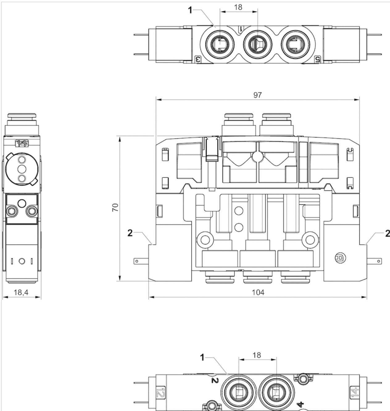
1) Anschlüsse [1 ,3 ,5, 2, 4] Ø 3/82) 2 Pilotventile mit externer elektrischer Verbindung
