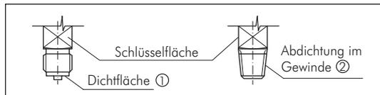
Das Anzugsmoment ist von der eingesetzten Dichtung abhängig. Um das Messgerät in die Stellung zu bringen, in der es sich am besten ablesen lässt, ist ein Anschluss mit Spannmuffe oder Überwurfmutter zu empfehlen. Sofern ein Druckmessgerät eine Ausblaskvorrichtung besitzt, muss diese vor Blockierung durch Geräteteile oder Schmutz geschützt sein. Bei Sicherheitsdruckmessgeräten (zu erkennen am (S)) ist darauf zu achten, dass der Freiraum hinter der ausblasbaren Rückwand mindestens 15 mm beträgt.
