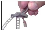
...Hand-Spannverschluss einhängen und ca. 3cm hinter das Hauptband zurücklegen...
