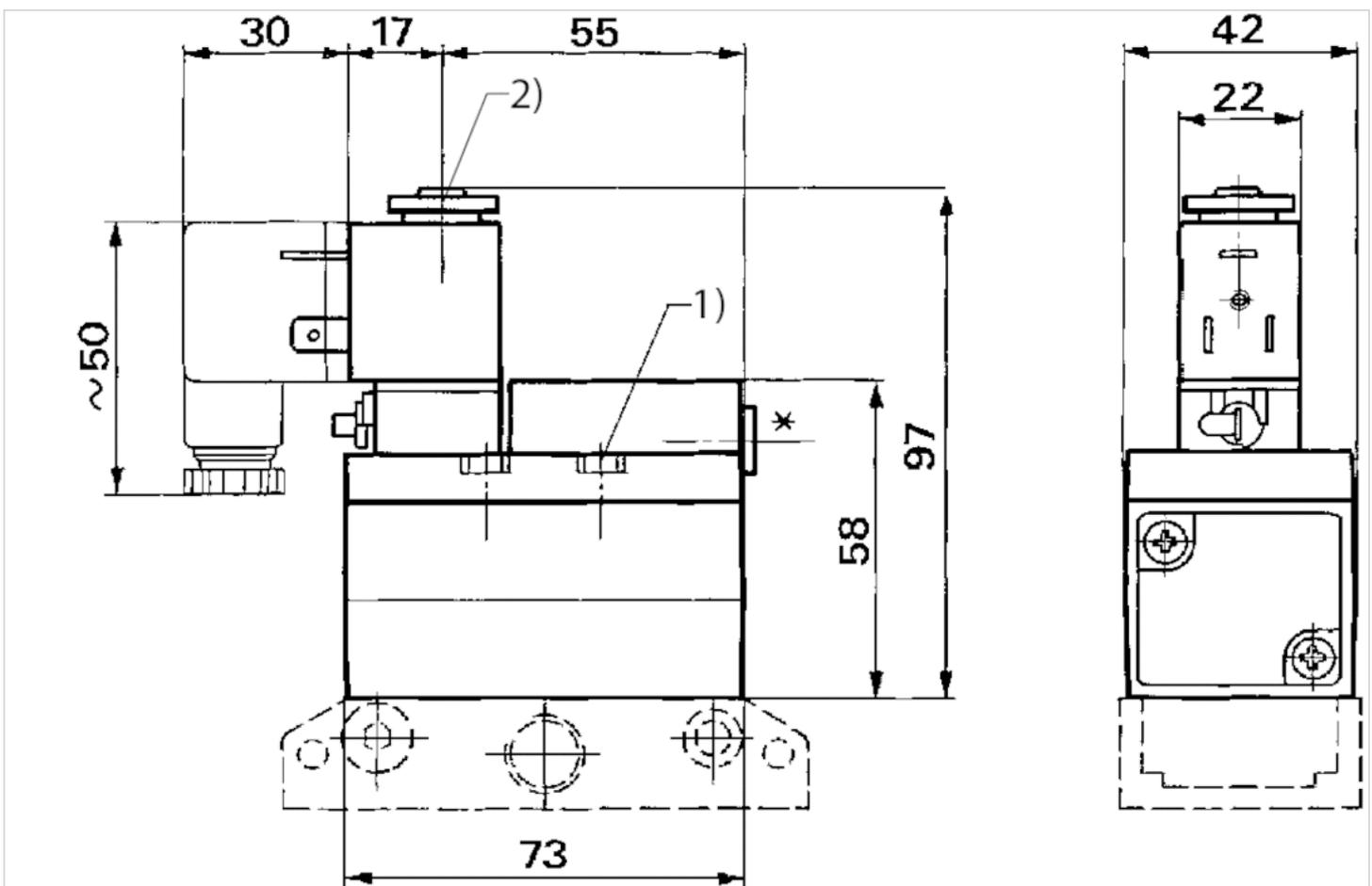
1) Anzugsmoment für Befestigungsschrauben:  $2,7 \pm 0,3 \text{ Nm}$  2) Anzugsmoment für Befestigungsmutter:  $1 \pm 0,2 \text{ Nm}$  Grundplatte nicht im Lieferumfang enthalten\* Mit Stopfen verschlossener Anschluss G 1/8 für separate Speisung
